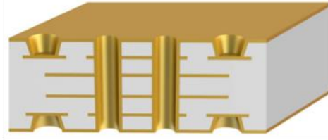
化学沉铜后 (孔壁绝缘基材覆盖铜)
