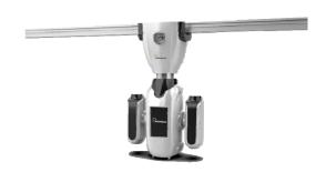
挂轨式巡检机器人采用轨道悬挂、云台升降、多传感器检测等方式,替代人工完成多种巡检、故障诊断、预警报警等任务,在节省了大量人工成本的同时并且提高了巡检效率和力度。该机器人可广泛应用于不同行业中的配电室、继保室、开关室等多种环境。
