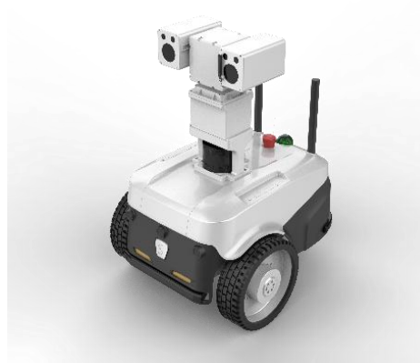
变电站轮式智能巡检机器人（三代）
