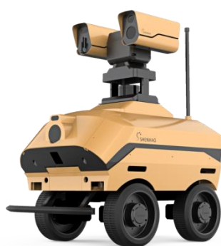
变电站轮式智能巡检机器人（二代）
