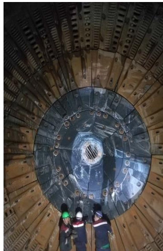
磨机停机检修维护更换衬板备件
