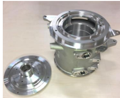
氢燃料电池汽车空压机电机壳
