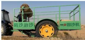
牵引式沙障铺设机(自主研发)
