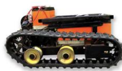
冲沙植树机器人(自主研发)
