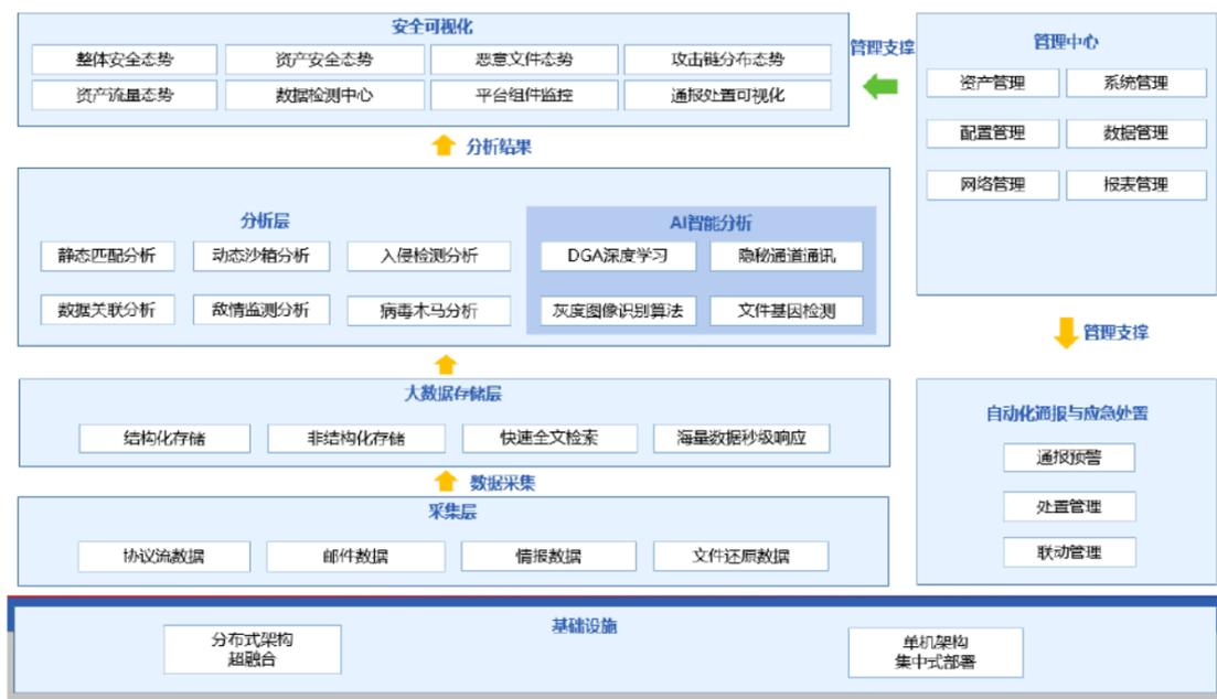
项目采用大数据分布式架构体系，使用接口通信，降低模块之间的耦合度，可以灵活的进行分布式部署。同时，对于小型场景提供单节点部署模式，有效降低小企业落地成本。通过异构计算模型，将各类计算设备通过高速网络连接而成并行计算环境。充分利用各个设备性能优势，完成应用任务。
