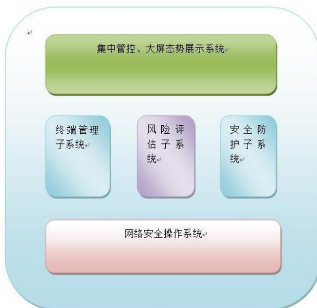
**终端管理系统：**主要实现终端识别、终端准入、终端私接/仿冒、终端阻断、终端在线/离线管理等功能。
