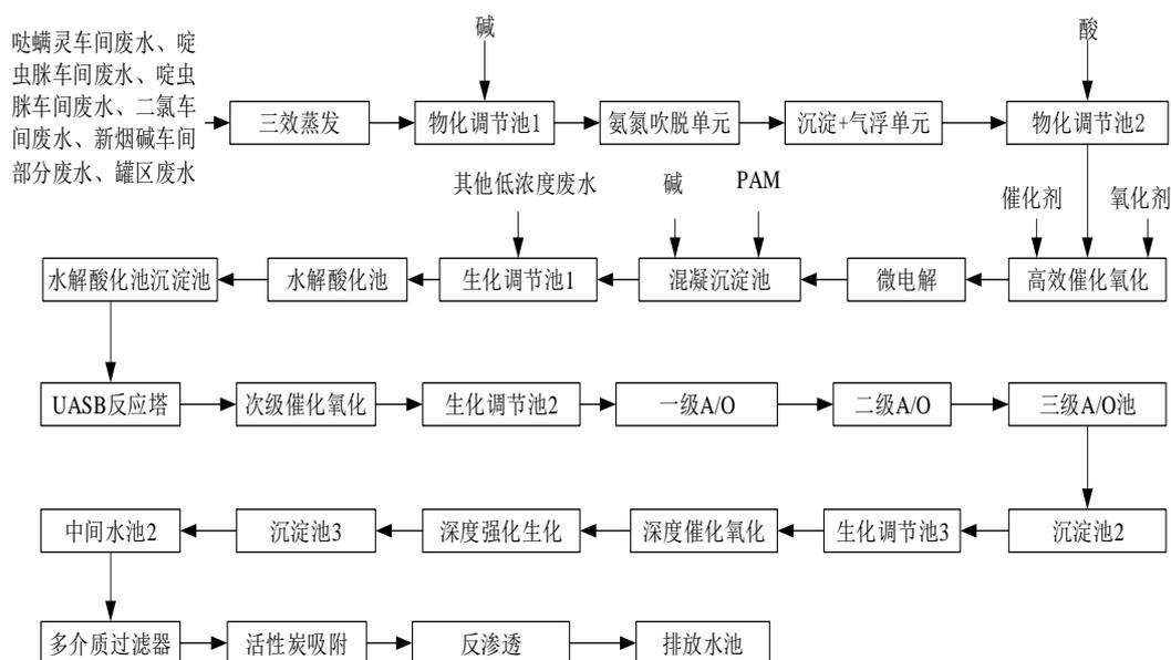
潍坊中农生化处理池设计能力 150 吨/天，经生化处理后的污水，接入园区污水处理厂。潍坊中农废水处理系统工艺流程如下：
